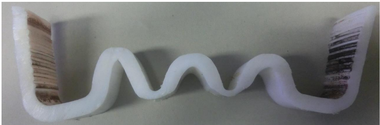
Abb. 2: Schlechte Ausformung des PTFE-Balgs mit extremer Wanddickenschwankung
